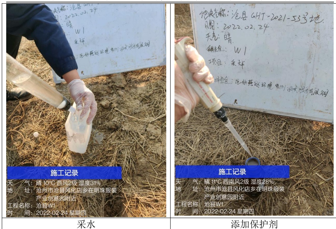
图4.2-3 地下水建井洗井、采样照片
