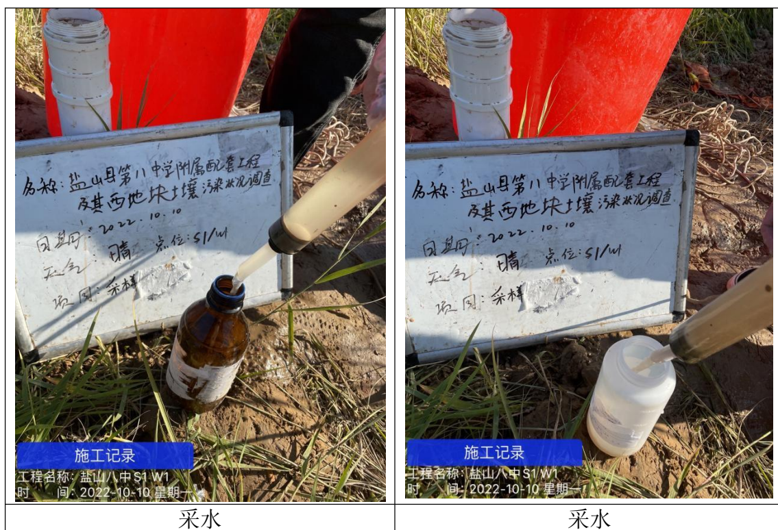
图4.2-2 地下水建井洗井、采样照片
